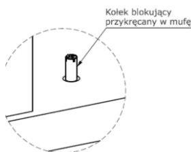
rys. 5 – kołek blokujący zamek
