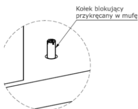
rys. 5 – kołek blokujący zamek
